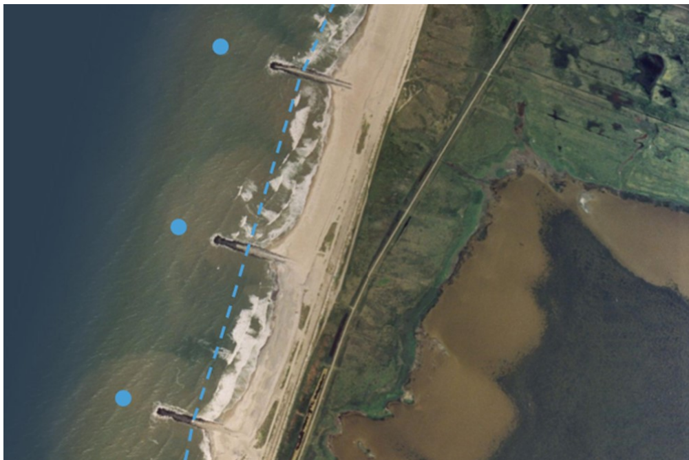
Figur 5.7 Høfder og klitbeskyttelse mod højvande. Blå prikker viser høfdernes oprindelige ende. Blå stiplede linje viser kystlinjen 40 år før baggrundsbilledet.
