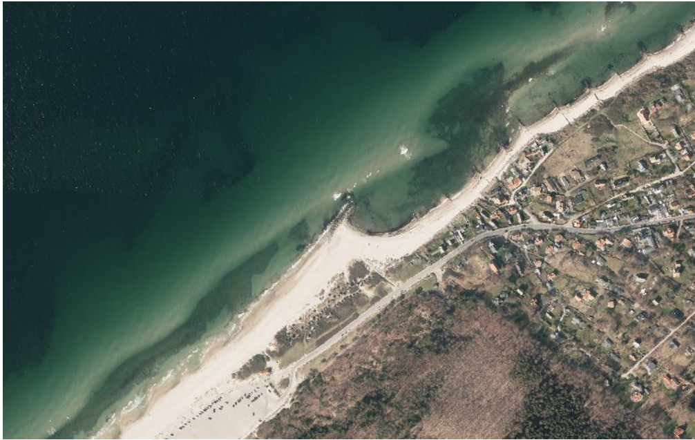
Figur 2.1 Eksempel på læsideerosion (molen i Tisvildeleje)
