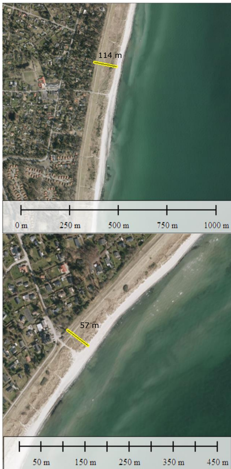
Figur 3-6 Øverste billede viser afstand fra bagsiden af diget til strandkant ved Bøtø by strand, afstanden er 114 m. Nederste billede viser afstanden fra bagsiden af diget til strandkant ved Sildestrup strand, afstanden er 57m.
