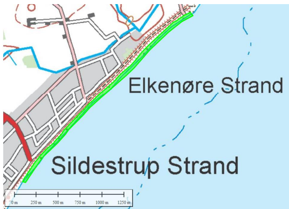
Figur 3-2 Område for inital sandfodring markeret med grøn over en ca. 2,7 km lang strækning.
